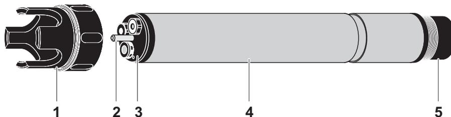
fig. 1-2 Architecture de la sonde AmmoLyt<sup>®Plus</sup> 700 IQ
